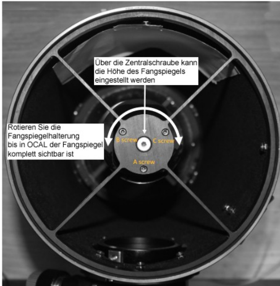
Abb. 4.2 Übersicht Fangspiegeljustage
